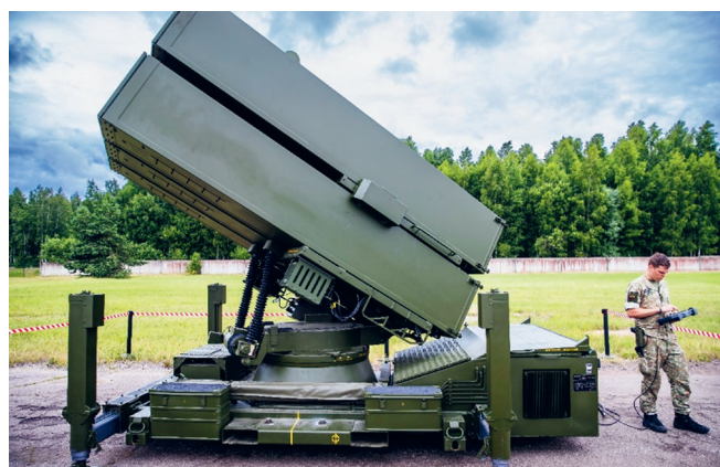
4.30 pav. | Oro erdvės gynybos sistema NASAMS, naudojama nuotoliniu būdu valdomiems orlaiviams ir sparnuotosioms raketoms, sraigtasparniams, lėktuvams ir kitiems taikiniais naikinti
