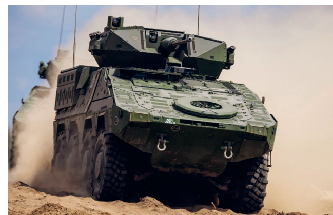
4.37 pav. | Pėstininkų kovos mašina „BOXER“ („VILKAS“), naudojama prieš gyvąjį jėgą ir techniką naikinti
