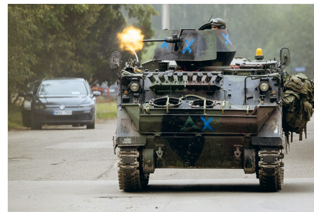
4.38 pav. | Šarvuotasis transporteris M113, naudojamas kariams ir kroviniams pervežti, taip pat atliekant vadovietės, ryšių centro, medicininės ir techninės evakuacijos funkcijas
