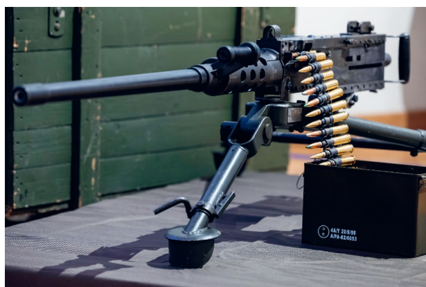
4.17 pav. | Kulkosvaidis M-2 „BROWNING“ (JAV) (kalibras – 12,7 mm, svoris – 42 kg)
