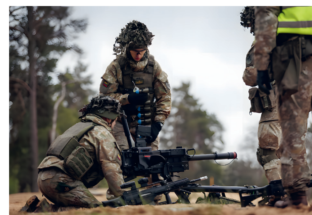
4.21 pav. | Automatinis granatsvaidis H&K GMG (Vokietija) (kalibras – 40 mm, svoris – 60,6 kg; maksimalus šūvio nuotolis – 2 200 metrų)
