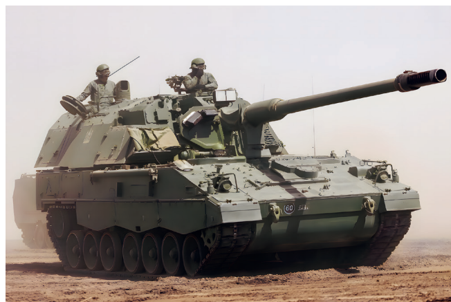
4.28 pav. | Haubica „PANZERHAUBITZE 2000“ (kalibras – 155 mm, šūvio nuotolis – 30 000–50 000 metrų; išsiskiria didele šaudymo sparta (10 šūvių per minutę) ir galimybe šaudyti išmaniaisiais sviediniais)
