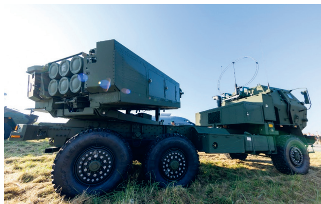
4.29 pav. | Artilerijos raketų sistema HIMARS – lengvasis daugkartinis raketų paleidimo įrenginys, skirtas šaudyti reaktivinių šaudmenų salvėmis, itin tikslus ginklas (didžiausias galimas šaudymo nuotolis – 300 km, didžiausias greitis – 85 m/h)
