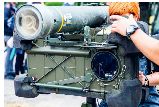
4.31 pav. | Raketinis oro erdvės gynybos kompleksas RBS-70, naudojamas nuotoliniu būdu valdomiems orlaiviams ir sparnuotosioms raketoms, sraigtasparniams ir kitiems taikiniais naikinti
